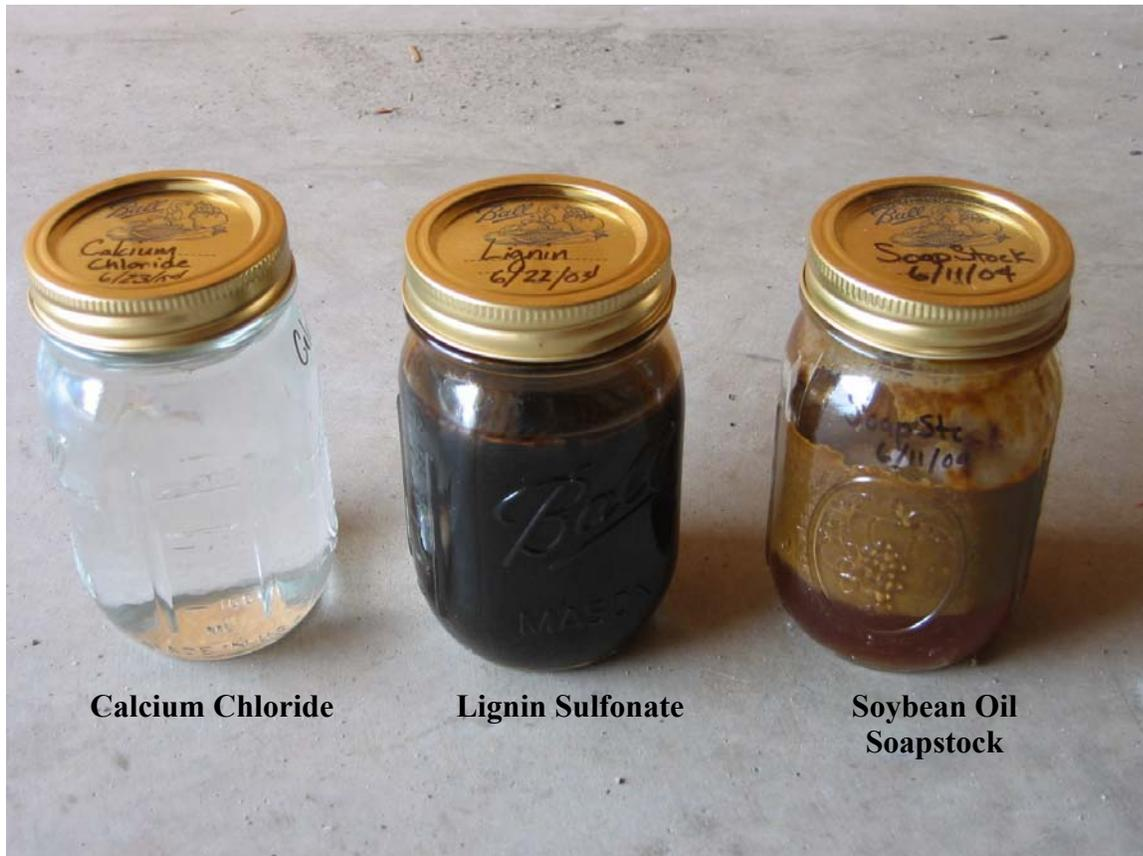
Figure 4.1.1. Dust suppressant samples.
