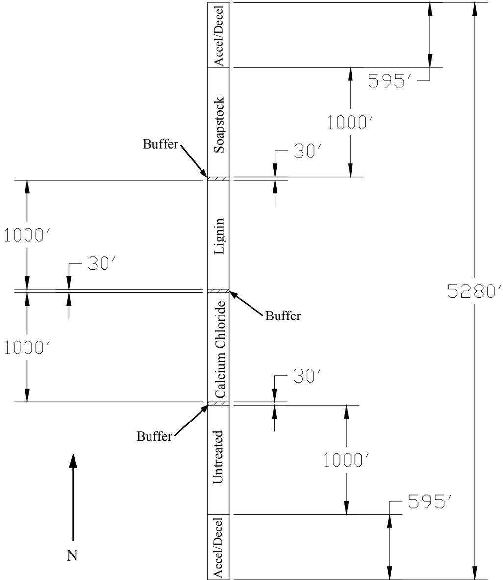
Figure 3.4.4. South 530<sup>th</sup> Avenue test section plan.
