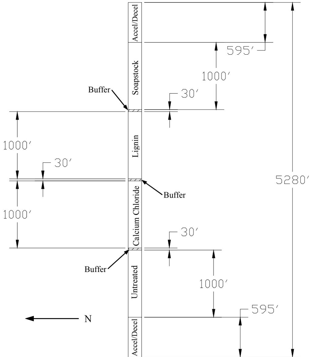
Figure 3.4.1. 260<sup>th</sup> Street test section plan.
